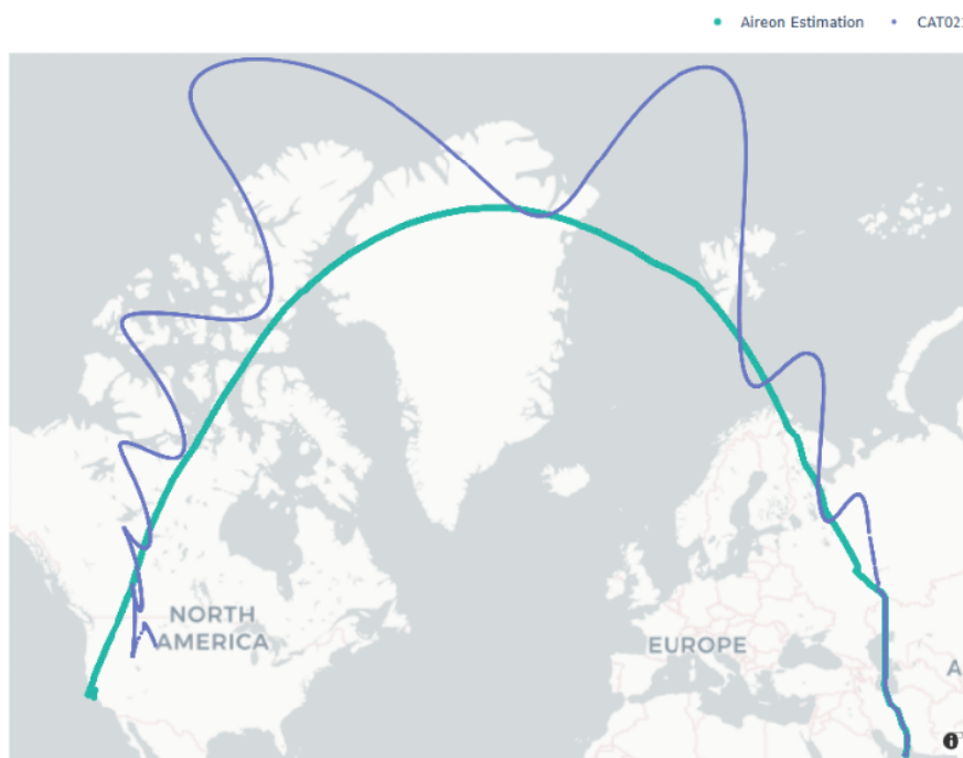
Figure 11. GNSS jamming map (affecting ADS-B reported positions) ¡Error! No se encuentra el origen de la referencia..
