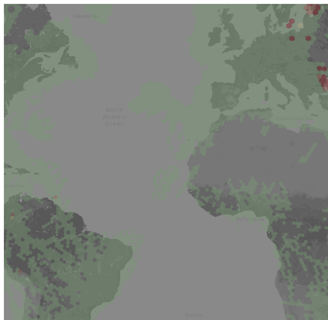
Figure 16. GNSS jamming map (affecting ADS-B reported positions) |Error! No se encuentra el origen de la referencia..
